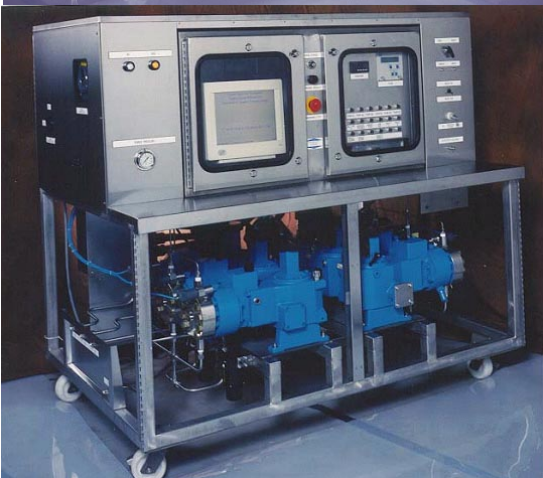
HPLC-Anlage 3300 3,3 Liter/min. bei max. 2.000 psi, Ex-Zone 1
